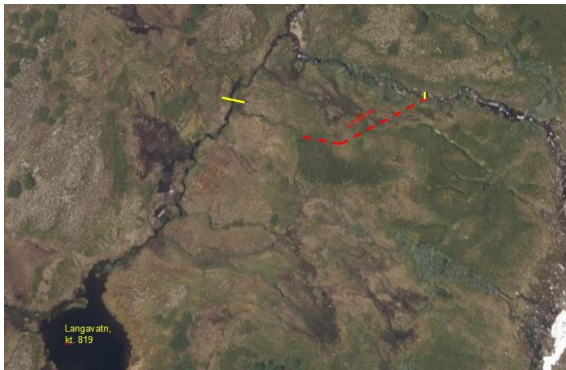
Figur 3.4. Planlagt lokalisering av sperredammer (gult) og kanal/rørgate (rødt) for overføring av bekken nord for Langavatnet.
